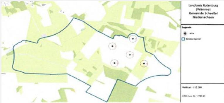
Das gesamte Plangebiet umfasst dabei eine Fläche von etwa 335 Hektar. Aufgrund einer mittleren Windgeschwindigkeit von 7,1 m/s bietet das Gebiet hervorragende Voraussetzungen für die nachhaltige Stromerzeugung durch Windenergieanlagen. Auch im Übrigen stehen innerhalb der Vorhabenfläche einer weiteren Windkraftplanung keine unüberwindlichen Restriktionen entgegen. Die Fläche ist hinreichend positiv geprüft, um als Vorranggebiet vollumfänglich durch die Regionalplanung ausgewiesen zu werden.
