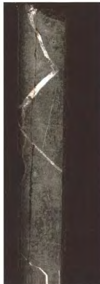
Abbildung 4: links: Schemazeichnung eines Petal-Centerline-Fractures der in einen Centerline-Fracture übergeht (nach EVANS 1980) rechts: Bohrkern mit einem Centerline Fracture (Bohrung: Ahausen Z1, Vulkanit, Teufe: 4794,73 m, Länge: 31 cm, Kiste: 49, aus WOLTER 1996)
