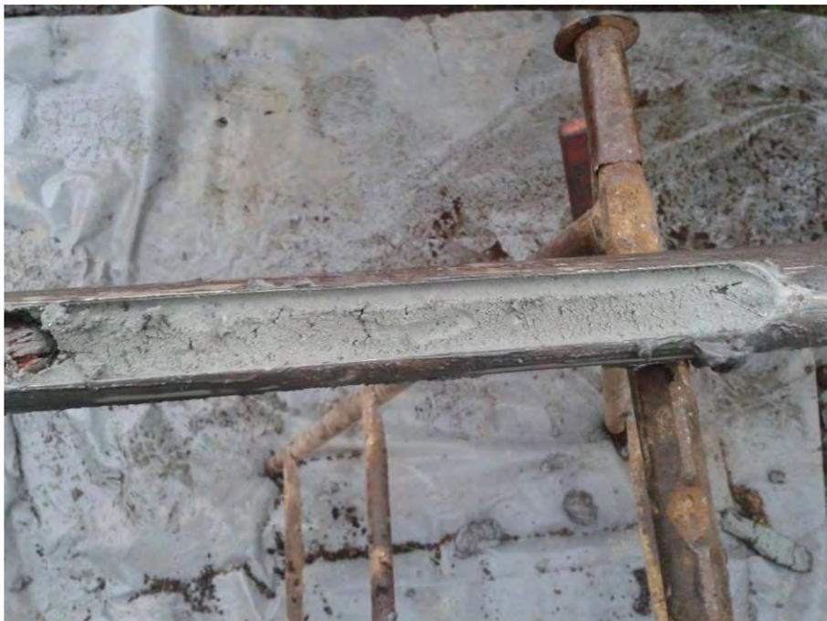
Foto 8: Bohrkern KRB 1: grauer Geschiebelehm aus dem Tiefenabschnitt zwischen ca. 4,2 m und 5,0 m u. GOK.
