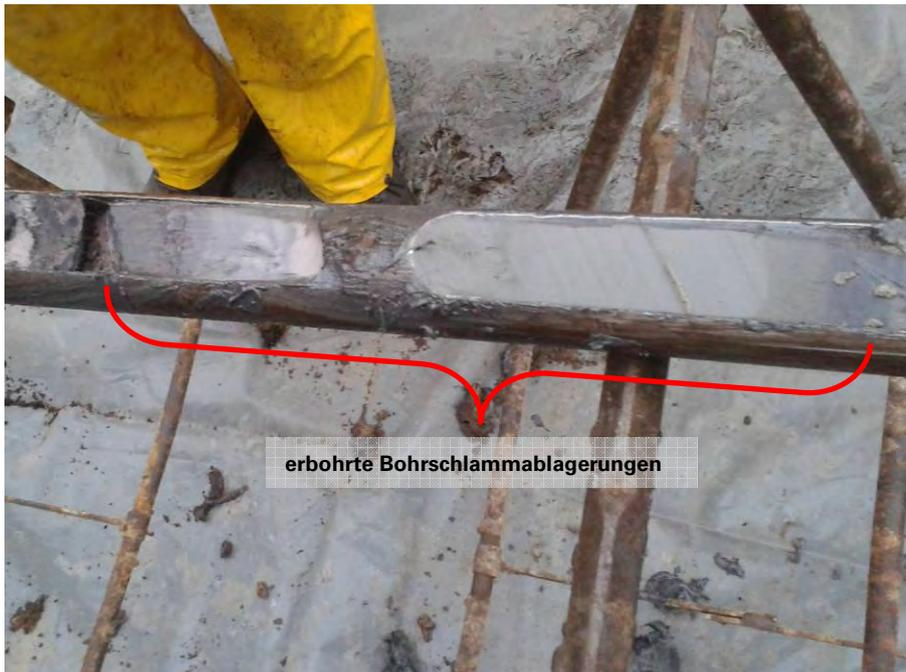
Foto 7: Bohrung KRB 1: erbohrte Bohrschlammablagerungen im Tiefenbereich zwischen ca. 1,0 m und 1,6 m u. GOK).
