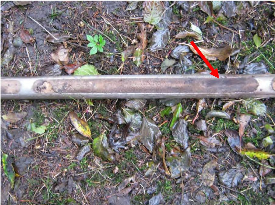
Foto 9: Bohrkern KRB 7: dunkelgrau gefärbter Bodenhorizont, geruchlich auffällig (aromatischer KW-Geruch) ca. 1,3 m u. GOK.
